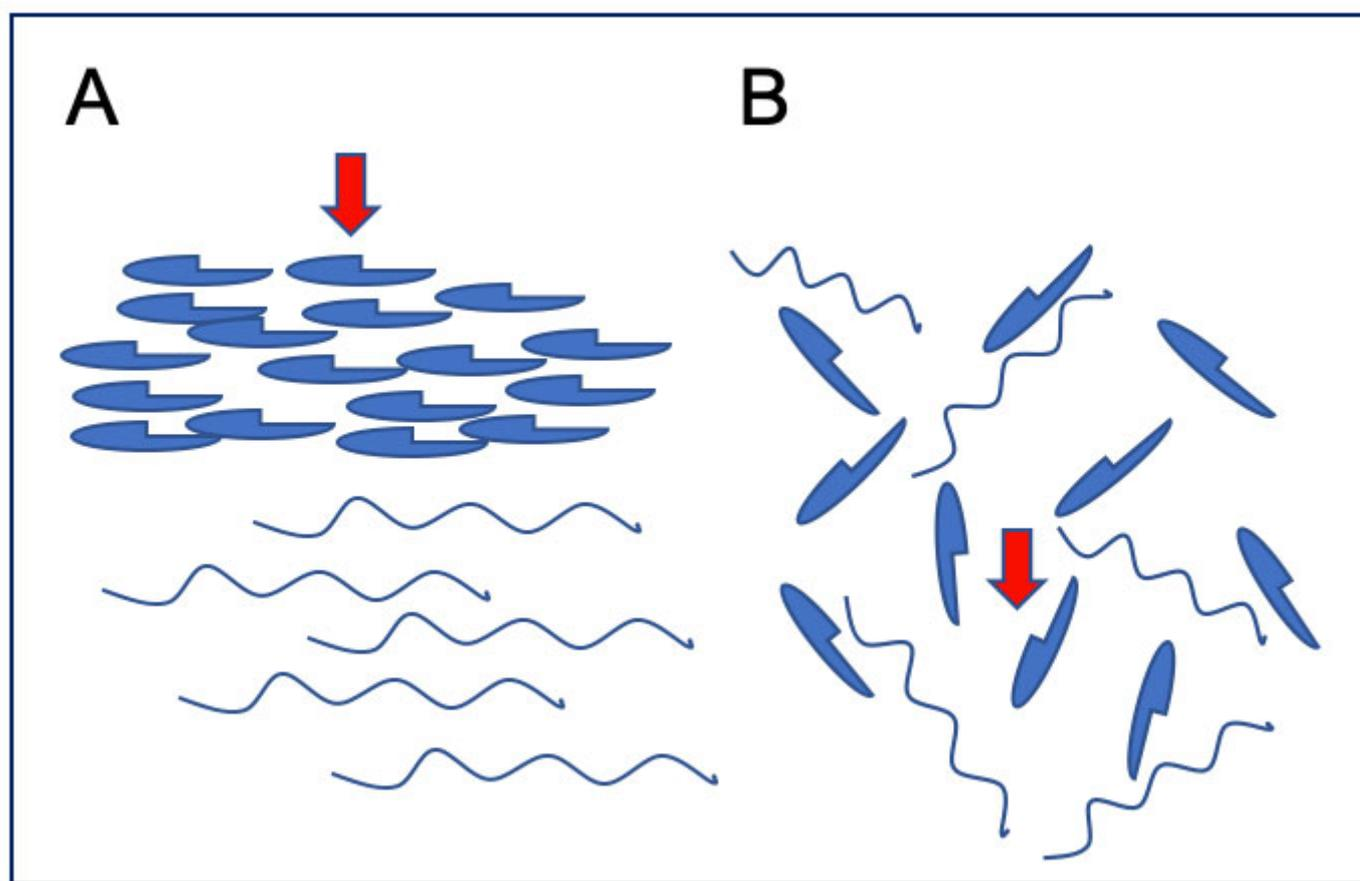
Figura 2. A) Partículas de arcilla en reposo (sistema sólido): el sistema puede soportar determinada carga; B) partículas de arcilla bajo movimiento (sistema líquido): la carga se hunde debido a la orientación aleatoria de las partículas de arcilla, permitiendo el ascenso del agua.
