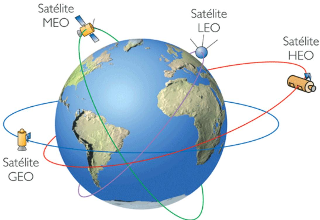
Los que operan a una altura comprendida entre 200 km y 800 km se encuentran en una región de órbitas bajas llamada LEO (Low Earth Orbit). Debido al rozamiento atmosférico, a menos de 200 kilómetros no está garantizada la estabilidad.
