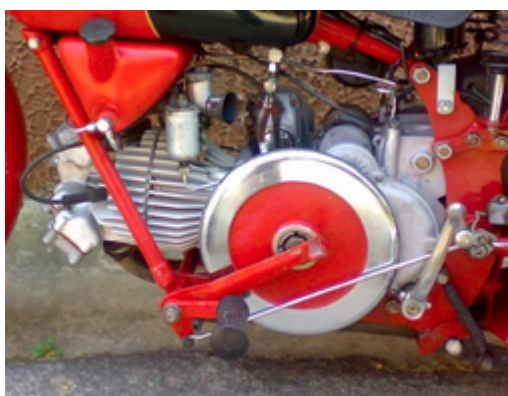
Volante de inercia de una motocicleta Guzzi
