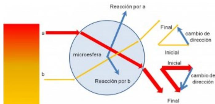
Figura 2. Microesfera atraída hacia la región donde la luz se enfoca (rojo)
